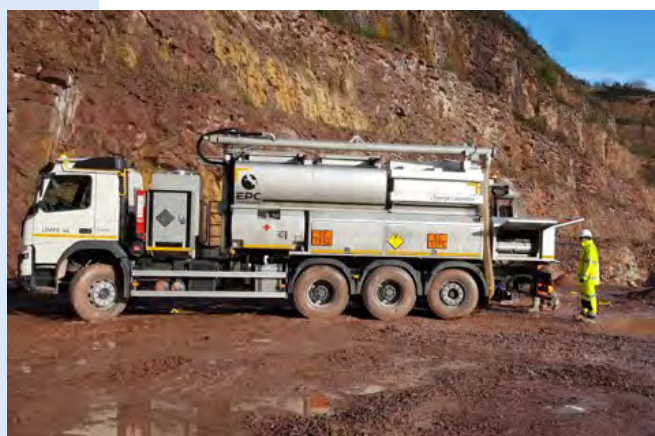
UMFE permettant la fabrication d'explosif sur site
