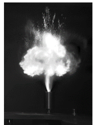
Allumage laser utilisant un dispositif de switch optique
