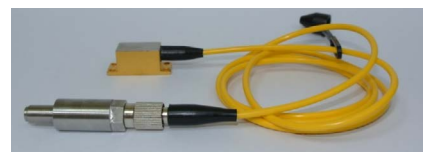
Détonateur opto-pyrotechnique développé à l'ISL
