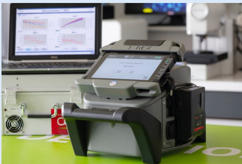
Dispositif portable de détection et d'identification de vapeurs d'explosifs
