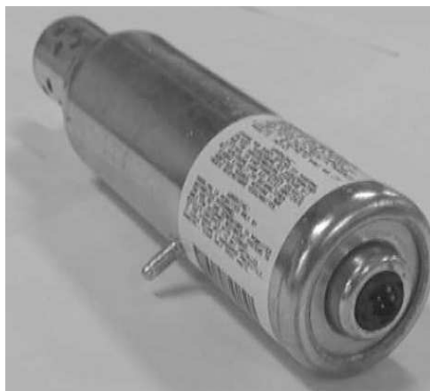
Générateur de gaz Passager simple.
